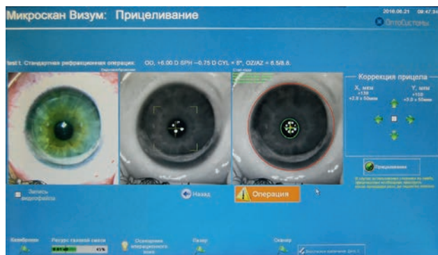
Рис. 4. Установка центрации воздействия перед проведением фотоабляции на эксимерлазерной установке Микроскан 500 Гц
